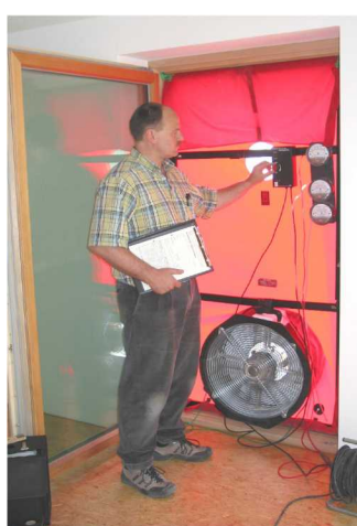
Blower Door Test (Luftdichtigkeitstest)
